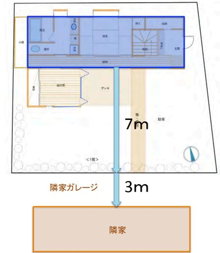
8畳グリッドは6畳間と縁側の組み合わせで8畳を形成します。グリッドは1つのユニットになって連なっていきます。柱がグリッドを形成するので空間はつながっています。そこに建具を建てれば空間を開けたり閉めたりすることで、壁をつくれば空間は閉ざされます。MEPの1階は[玄関&階段のユニット]、[寝室のユニット]、[水回りのユニット]、そして[結生の間のユニット]が連なり、2階は[書斎&階段のユニット]、[茶の間のユニット]、[キッチンユニット]が連なります。車道が東側を走るので東端が玄関ユニットになりましたが、もし北側を走ったら玄関ユニットは中央に位置づけられるかもしれない…といった具合に、ユニットはパズルのように右に左に自由に位置を変えて連なります。
