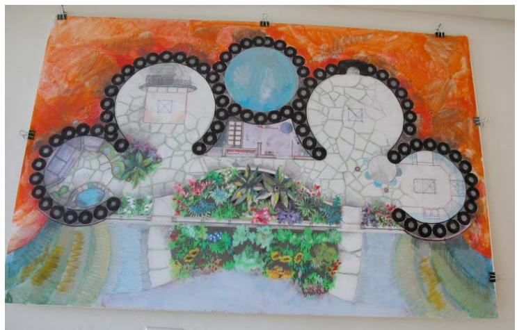
古タイヤをU字型に積んで、土で固めることで建築ができる。
